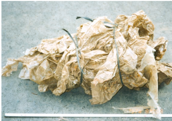
⑩ 最終処分場行き（劣化が激しい）
