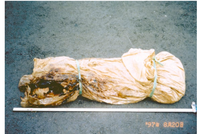
⑥ 劣化・日焼けが多い (結束ひも×)
